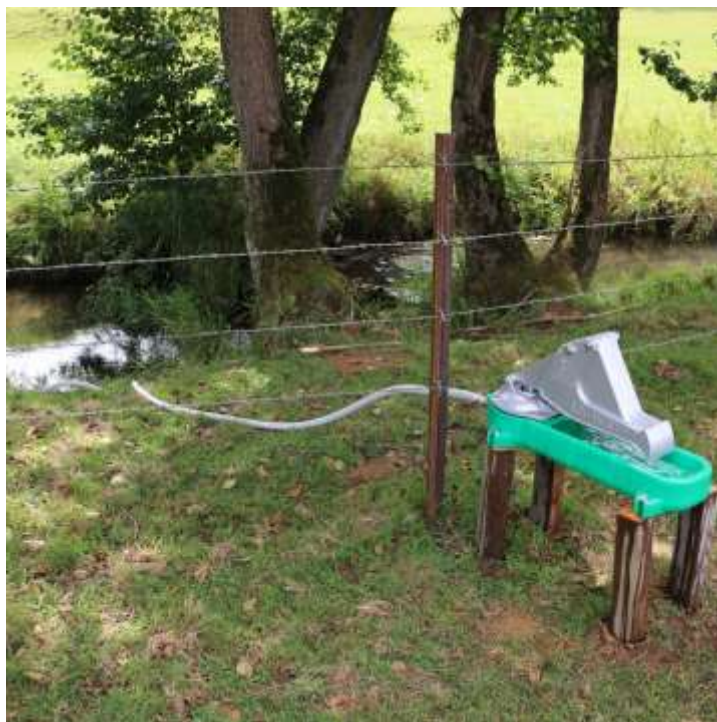
Slika 2: Membranska pašna črpalka z enim napajalnim mestom.
