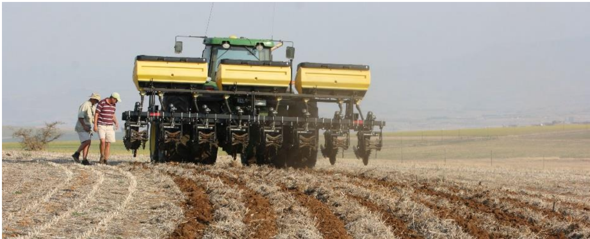
Slika 4: Trakasta setev (Stripe till)
