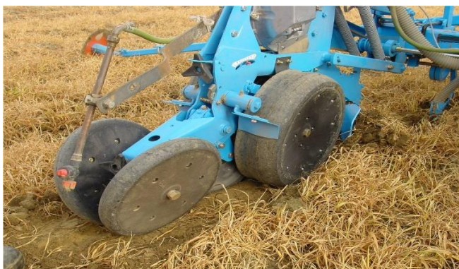
Slika 3: No-till sejalnica za presledno setev
