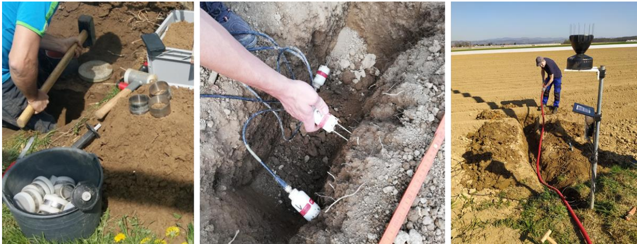
Slika 7: Delo na terenu za vzpostavitev sistema SPON. Odvzem vzorcev, vgradnja merilnikov vsebnosti vode v tleh in povezava merilnikov s komunikacijsko napravo.
