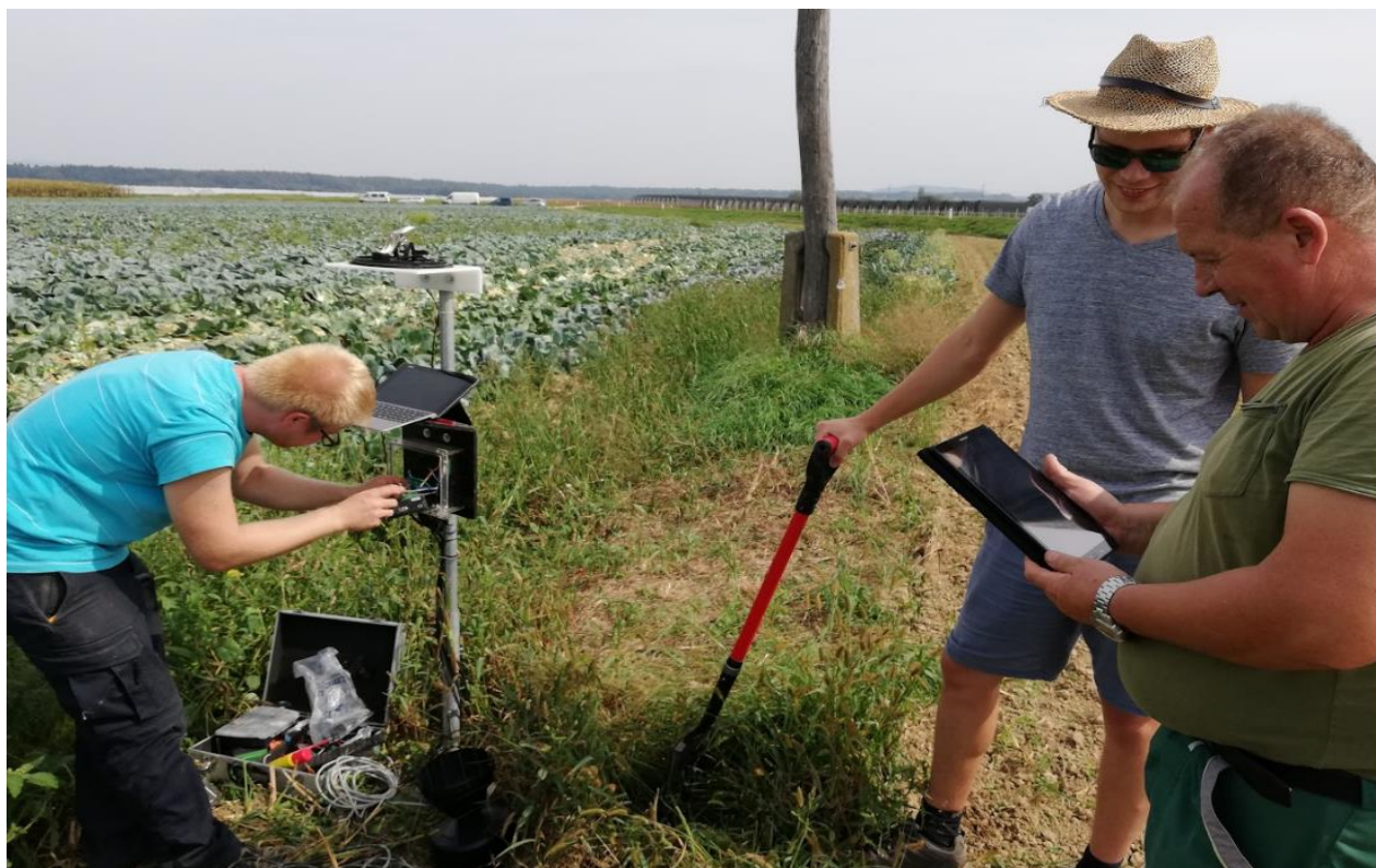
Slika 8: Namestitve opreme na način da ne moti pridelave (dežemer in komunikacijska naprava izven območja namakanja), sonda za merjenje vode v tleh se nahaja v samih tleh na območju namakanja. Hkrati poteka seznanjanje pridelovalca z opremo in meritvami.
