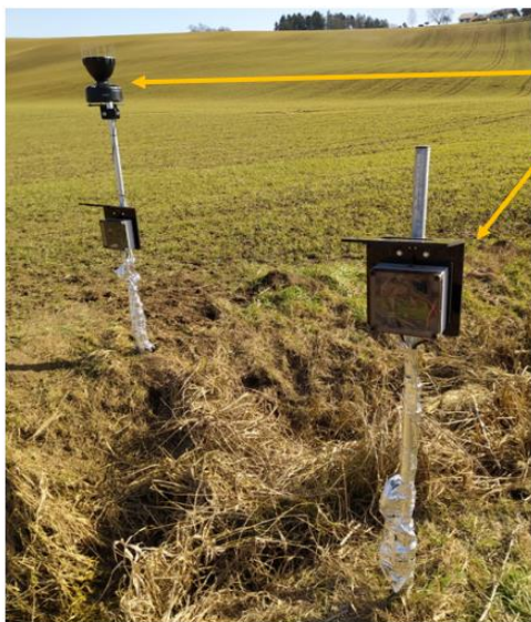
Slika 2: Nadzemni del sistema za merjenje vsebnosti vode v tleh (solarno napajanje baterije in dežemer).
