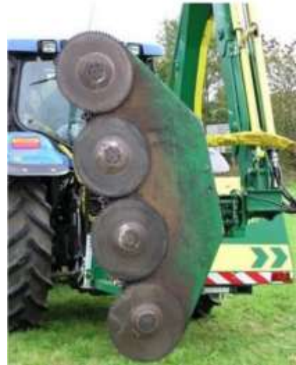
Slika 8: Primeren traktorski priključek za izvajanje čistega reza (vir: MKGP).
