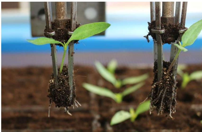
Slika 4: Robot za pikiranje sadik omogoča hitro in natančno presajanje (Vir: Spletna stran Zeleni svet)
