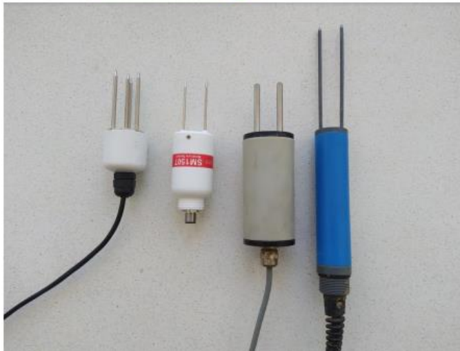
Slika 12: merilniki vsebnosti vode v tleh
