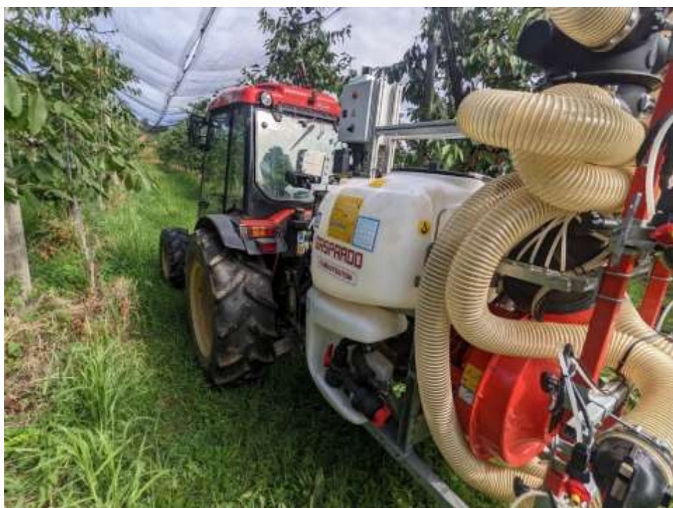
Slika 10: Pršilnik z nastavljimi izstopnimi cevmi nagrajen s senzorskim sistemom.
