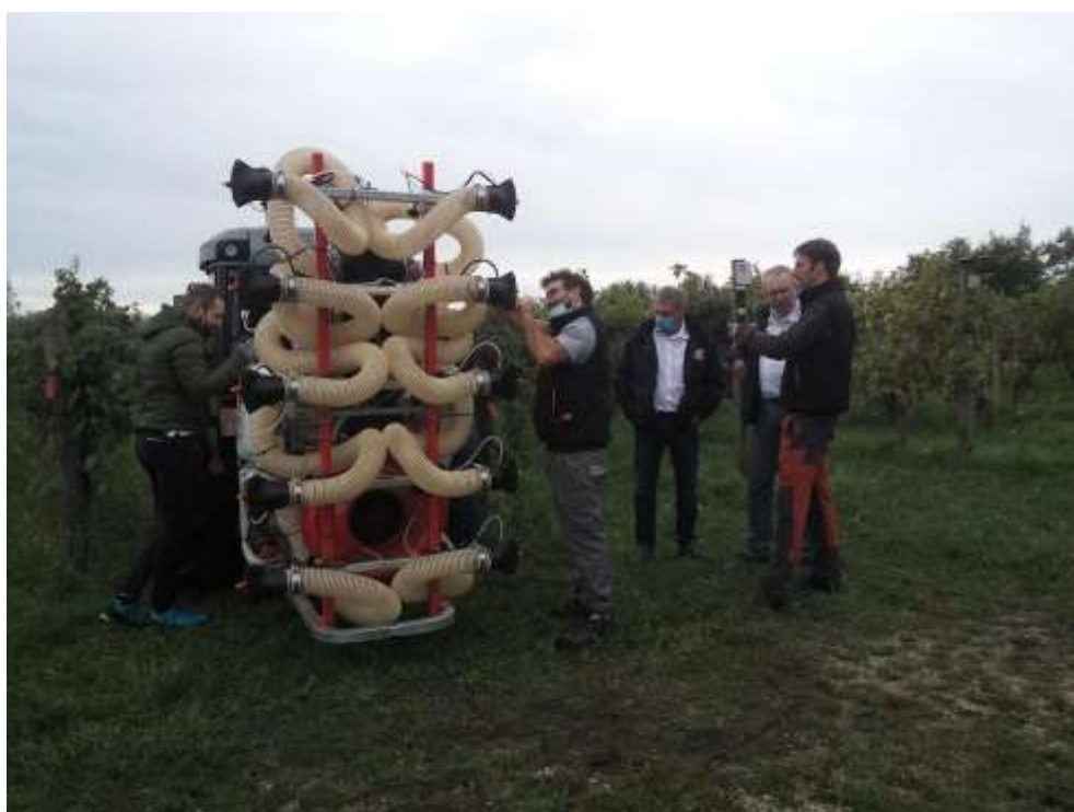
Slika 12: Pršilnik z nastavljivimi izstopnimi cevmi nagrajen s senzorskim sistemom na delovni operaciji v vinogradu.
