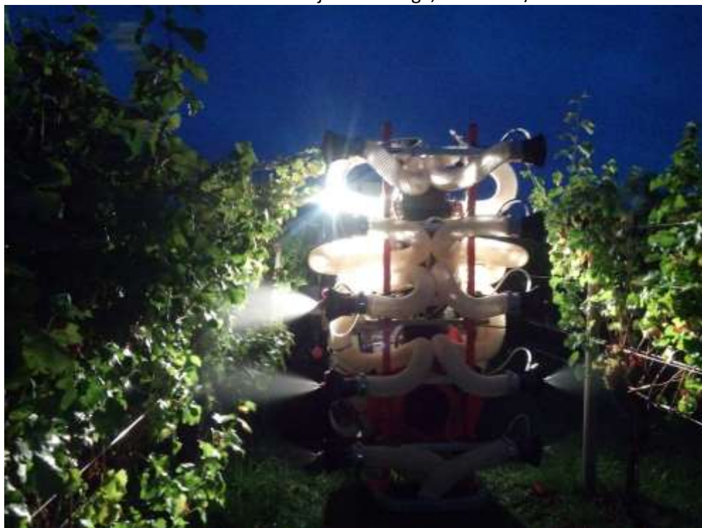
Slika 11: Pršilnik z nastavljivimi izstopnimi cevmi nagrajen s senzorskim sistemom na delovni operaciji v vinogradu.
