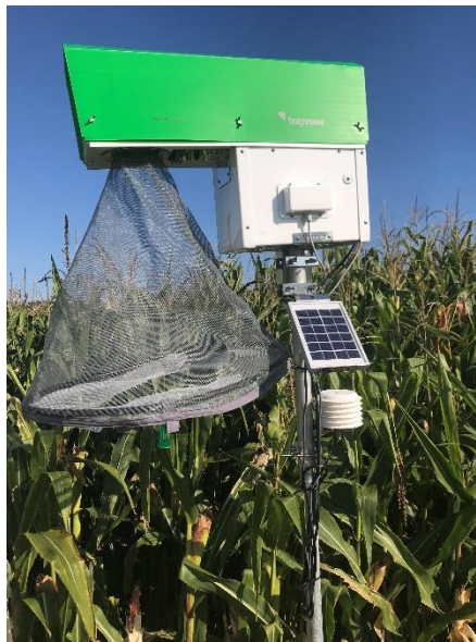
Slika 4: Elektronska past Trapview za spremljanje naleta koruzne veščice
