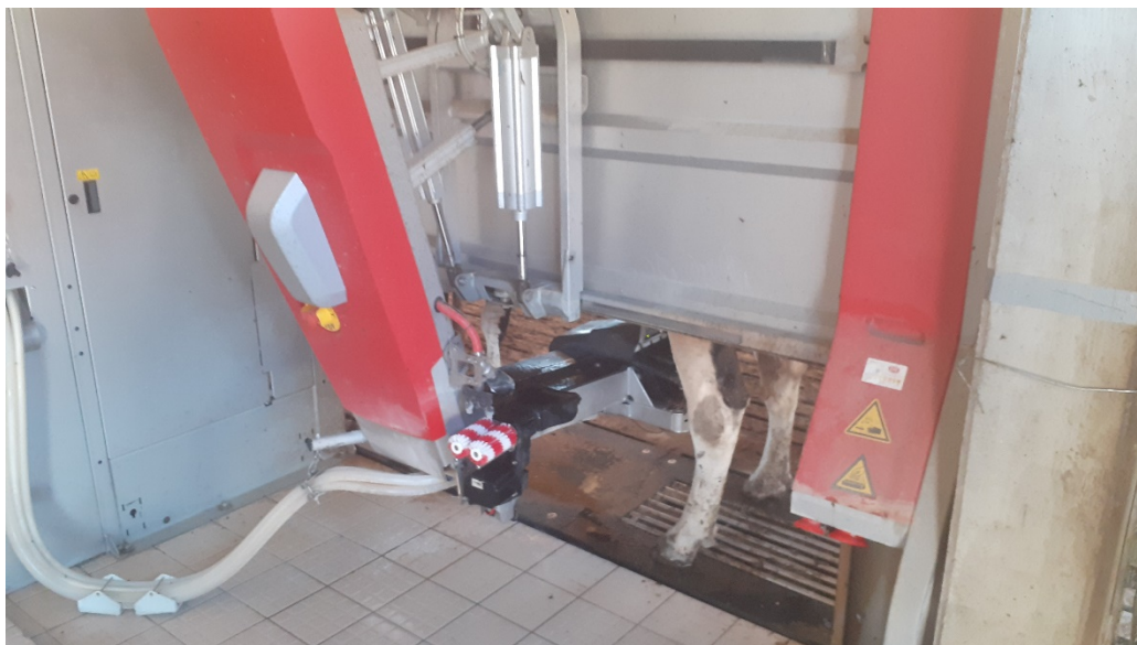
Sika 3: Avtomatska molža, molzni robot poleg molže omogoča še spremljanje številnih podatkov o živali, ki so pokazatelji njenega zdravja (foto, Hohler)
