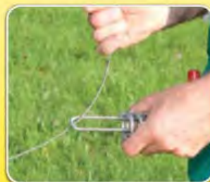
Žico speljati v okvir jeklene vzmeti
