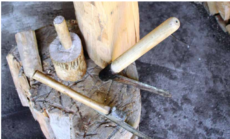
Orodje za izdelavo skodel: lesen klin za razcepljanje, kij iz gabrovega (ali kakega drugega trdega) lesa, sekira šinklarica (dešivnica) in tesarska sekira žapoha.
