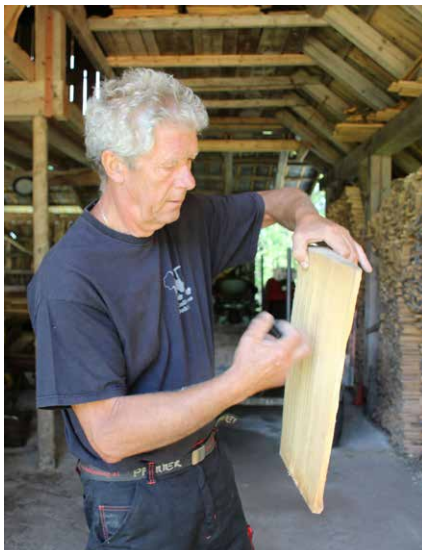
S potrkanjem se ugotovi zven lesa, s tem pa njegova kakovost in uporabnost.
